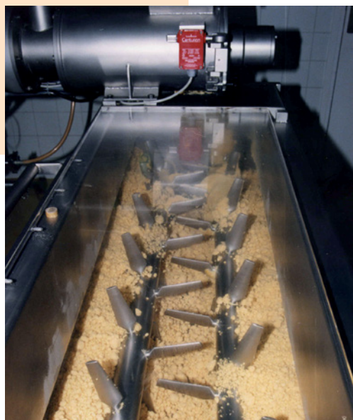
Dettaglio della lavorazione dell'impasto nella vasca (Storci).
